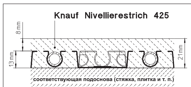
Выравнивающая масса Knauf Nivellierestrich 425 (минимальная толщина стяжки над трубой 8 мм, общая толщина 21 мм)
